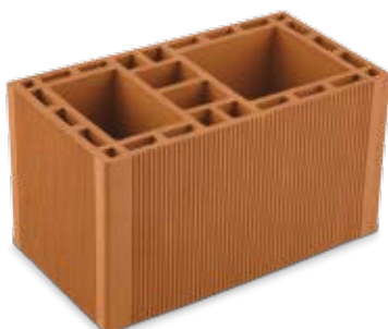
Bloco Estrutural 7 MPa 19 x 19 x 34 cm Peso: 7,37kg | Quant. Pallet: 146
