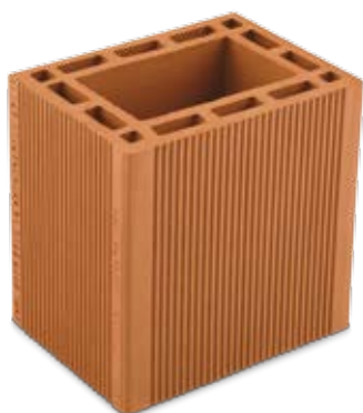
Bloco Especial 7 MPa 19 x 19 x 14 cm Peso: 3,66kg | Quant. Pallet: 336
