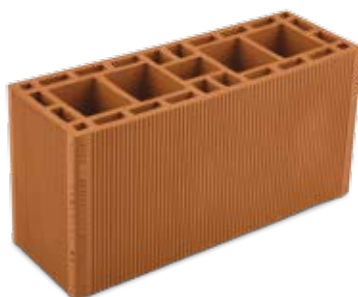
Bloco Estrutural 7 MPa 14 x 19 x 39 cm Peso: 7,54kg | Quant. Pallet: 168
