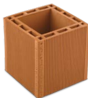
Bloco Especial 7 MPa 19 x 19 x 19 cm Peso: 4,27kg | Quant. Pallet: 252
