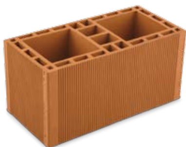
Bloco Estrutural 7 MPa 19 x 19 x 39 cm Peso: 7,93kg | Quant. Pallet: 126
