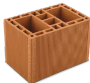
Bloco Estrutural 7 MPa 19 x 19 x 29 cm Peso: 6,6kg | Quant. Pallet: 168
