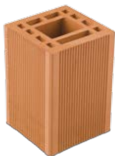
Bloco Estrutural 11,5 x 19 x 14 cm Peso: 2,830kg | Quant. Pallet: 492
