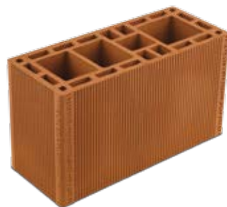
Bloco Estrutural 7 MPa 14 x 19 x 34 cm Peso: 6,45kg | Quant. Pallet: 162
