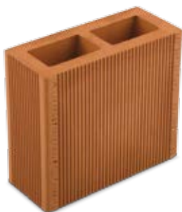
Bloco Vedação 9 x 19 x 21 cm Peso: 3,900kg | Quant. Pallet: 309
