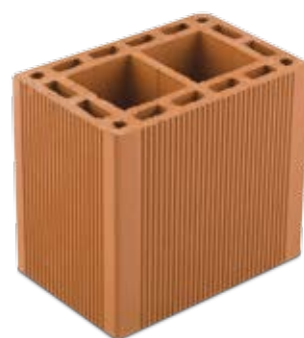
Bloco Especial 7 MPa 14 x 19 x 21 cm Peso: 4,36kg | Quant. Pallet: 280
